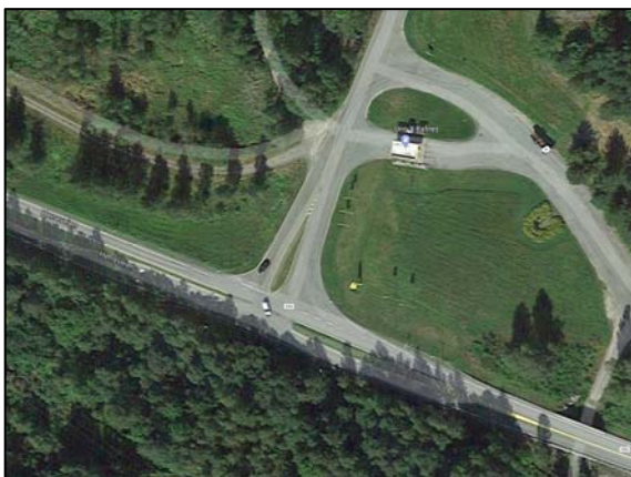
Figur 3-16 Avkjøring til Rafnes. Kanalisert kryss mellom fv. 353 og avkjøring til Rafnes industriområde. 35 m langt venstresvingefelt fra nordvest. (google.com/maps, 21.02.2019)
